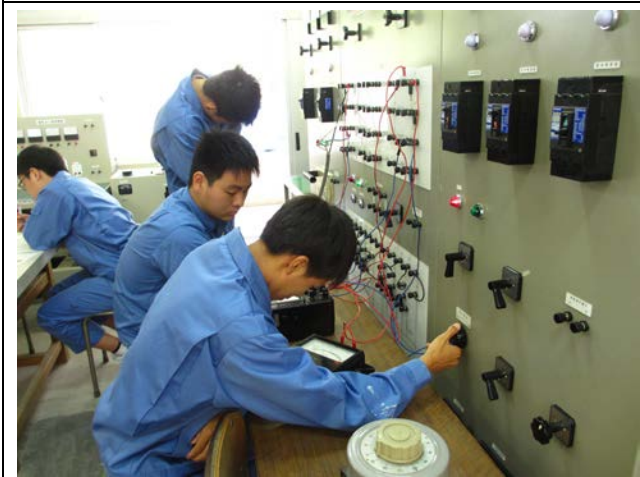
電気応用(模擬送電線路特性試験)
